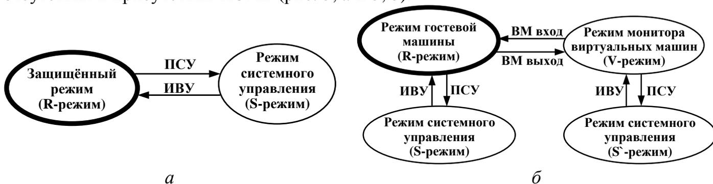
Рисунок 3 – Схемы переключения между режимами работы процессора при выполнении набора безусловно перехватываемых ПОАВ инструкций в случаях отсутствия ПОАВ (а) и присутствия ПОАВ (б)
