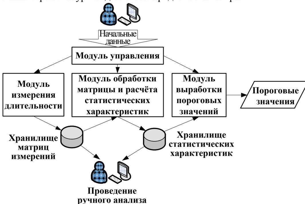
Рисунок 9 – Архитектура подсистемы выработки пороговых значений
